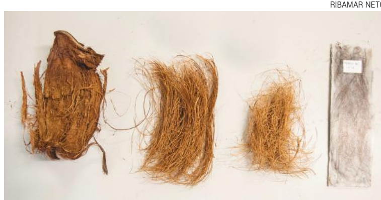
Transformação da fibra do coco desde seu estado natural
